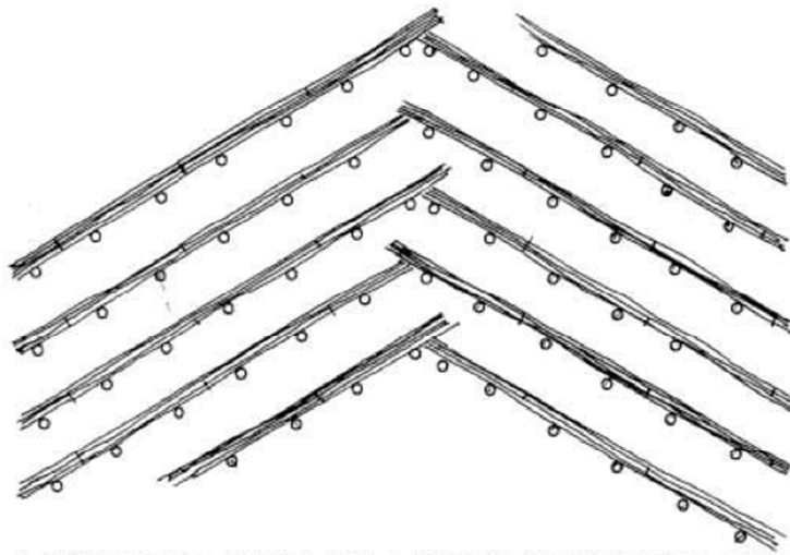
DISPOSIZIONE DEL SISTEMA DELLA "RETE DI FASCINATE" SUL VERSANTE A LISCA DI PESCE.
