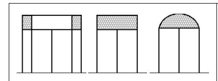
ESEMPIO 1: Al piano terra dei fabbricati in presenza di vano di ingresso ampio, il condizionatore può essere posizionato all'interno del vano, inserito nell'infisso o nella cornice in corrispondenza del sopraluce o ai lati, previa opportuna schermatura delle bocche di aspirazione.
